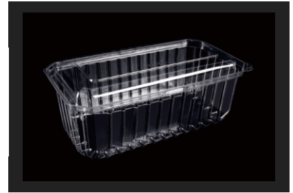
型号: JM-J036 装箱: 250个 材质: PET 尺寸: (外) 245mm*130mm*100mm (内) 230mm*115mm*97mm
